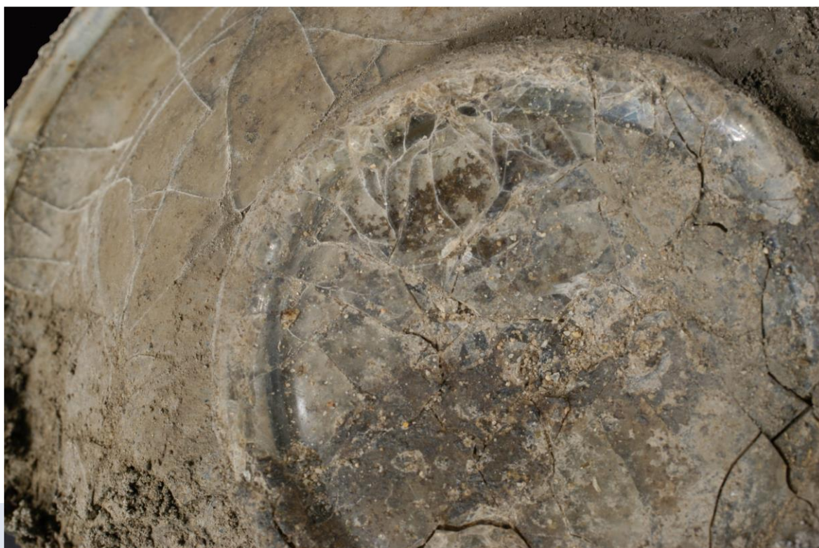
Foto: Glas van degradatieklasse 3 heeft een structuur van zeer kleine brokjes (zg. suikerglas) is zeer kwetsbaar en mag daarom alleen en bloc gelicht worden.
