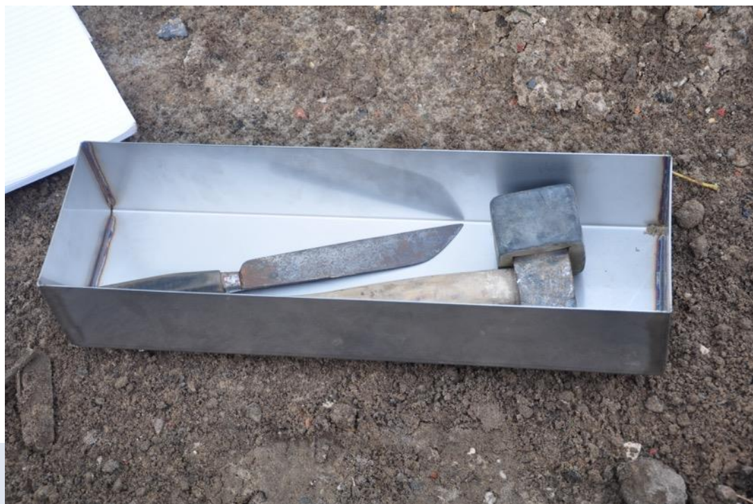
Foto: Monsterbak en gereedschap voor het nemen van een micromorfologisch monster uit een profiel.
